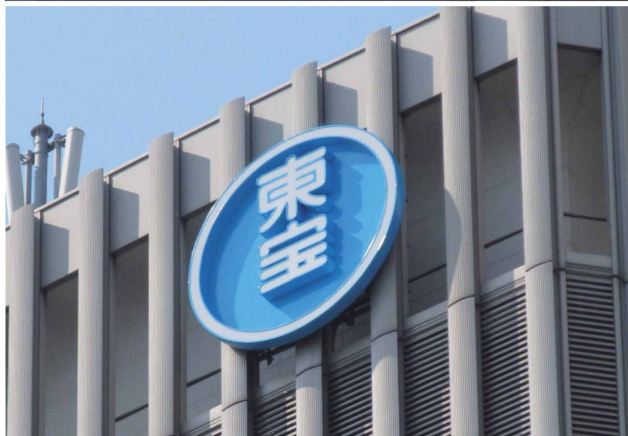
2014年6月にリニューアルされた有楽町マリオン壁面の東宝のサイン。LEDモジュールは桜井の「Bandilight F-LED413(青)」、LED用電源はTDKラムダの「HWS150A-12V」、マーキングフィルムは桜井が販売する「Viewcal」を使用。
